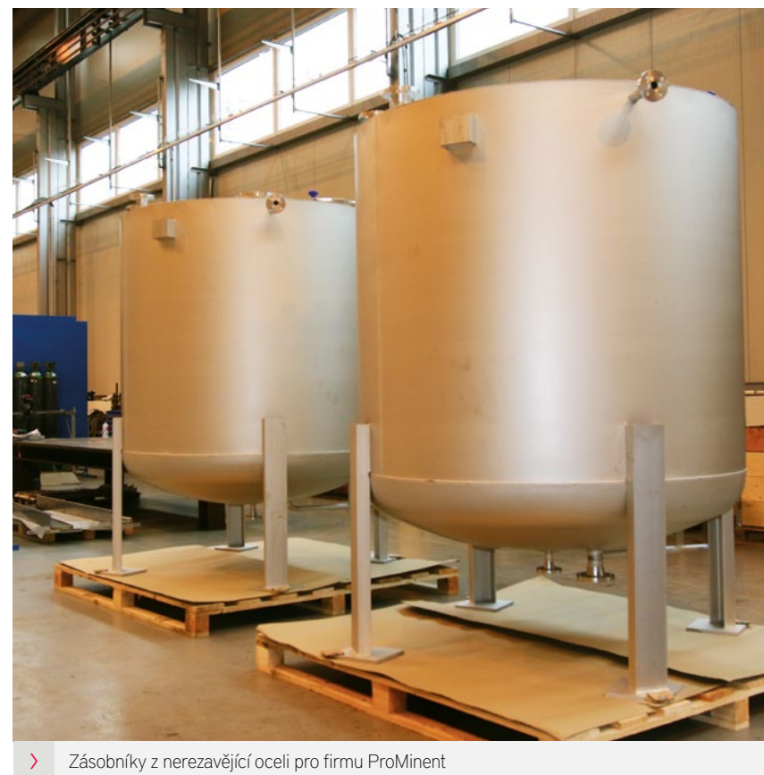
Zásobníky z nerezavějící oceli pro firmu ProMinent
