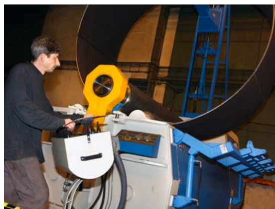
Nové zakružovací válce v provozu
