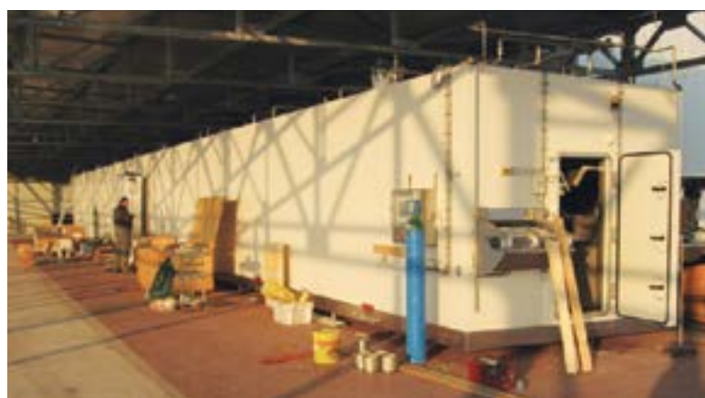
JBT: Mrazák FPF v 3-sekčním provedení, KASPER KOVO vyrábí 2 x 8 sekcí, 1 sekce s rozměry 4 x 3 x 3 m
